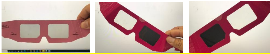
方法二、電腦或平板螢幕貼透明膠帶，再以偏振片「旋轉」觀察顏色變化
